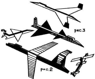
Летающую модель самолёта сделайте из листа тетради, альбома для рисования или старой газеты. Размеры заготовки 130×100 мм, возможны и другие, но не больше чем 300×220 мм. Согните заготовку пополам. На неё нанесите контуры балансирной нагрузки — 1, фюзеляжа — 2, крыла — 3, горизонтального — 4
